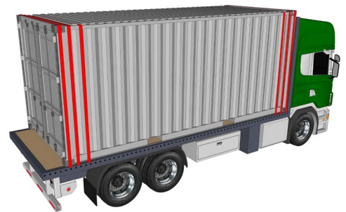
Tomcontainer (2,6 ton) med gummimellanlägg men med frost på flaket säkrad med 6 överfallssurrningar.
