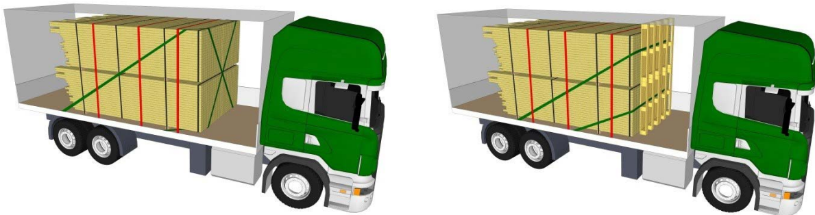
Exempel på säkring av virkespaket med överfallssurrning och grimmor.
